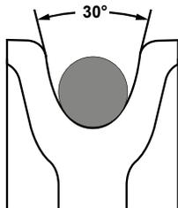
El perfil de polea es una característica muy importante de todas las poleas. McKissick fabrica poleas estándar para el uso general en aplicaciones de guía de cable para izaje cumpliendo con las especificaciones mínimas de API. Este perfil tiene un ángulo de muesca incluido de 30°. El perfil de muesca se utiliza en grúas móviles, plataformas de perforación, unidades de trabajo, pastecas de tubería, pastecas de desplazamiento, pastecas de corona y muchas otras aplicaciones de izaje generales.
