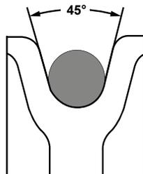
La norma DIN 15061 sobre dispositivos de izaje define los perfiles de muesca para las poleas para cable.
