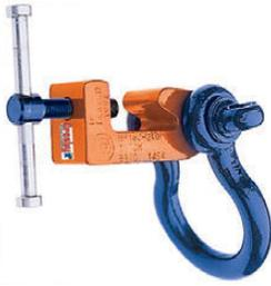
La garra para astilleros IPBTO/10 puede utilizarse como ojo de aparejo temporal en espacios que hayan sido reforzados con perfiles HP (con nervio), tales como salas de máquinas y secciones del barco. Esta garra tiene un husillo roscado para una instalación más fácil de la garra. En el momento en que se aplica una carga, la garra se fija automáticamente.
