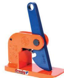
Las garras de izaje horizontal IPH10 con tensión por resorte tienen una función de pre-tensionado que permite al usuario ajustar las garras al material para el izaje y traslado horizontal de materiales rígidos. Estas garras deben usarse en pares o más.
