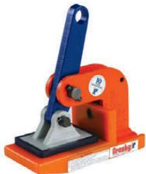
Las garras de izaje horizontal IPHNM10 tienen una función de pre-tensionado que permite al usuario ajustar las garras al material para el izaje y traslado horizontal de materiales rígidos. Sirve para casos en los que la superficie del material no debe dañarse. Estas garras deben usarse en pares o más.
